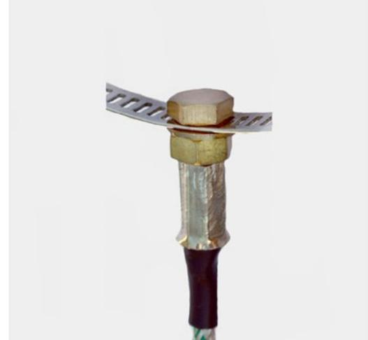
Für Temperaturmessungen an Rohren bis 400 °C sind diese Rohrschellen-Thermoelemente in unterschiedlichen Größen für unterschiedliche Rohrdurchmesser lieferbar. Bei dieser Bauform kommt die Messspitze in direkten Kontakt mit der Rohrwandung. Somit wird eine schnelle und punktuelle Messung mit geerdeter Messstelle ermöglicht.
