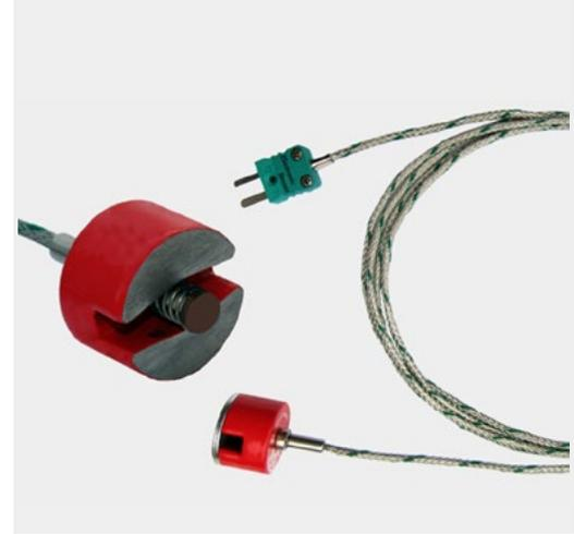
Das Oberflächen-Magnet-Thermoelement eignet sich ideal für Temperaturmessungen bis 450 °C auf metallischen und ferromagnetischen Oberflächen, ohne das Bauteil zu beschädigen. Der selbsthaftende AlNiCo-Magnet mit hoher Haltekraft (20 Kp) gewährleistet zuverlässigen Halt. Die federnde Messsonde mit einem 7 mm Kupferplättchen ist galvanisch mit dem Thermoelement Typ K verbunden. Die Anschlussleitung hat abisolierte Enden, optional mit Zugentlastungshülse und Thermostecker erhältlich.
