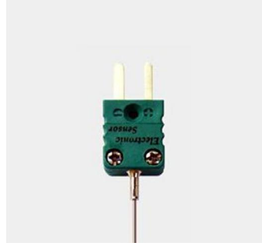
Mantelthermoelemente mit Miniaturstecker von Electronic Sensor werden direkt mit einem Miniaturstecker versehen. Durch kurze Ansprechzeiten und geringe Materialabmessungen eignen sich diese gut für schnelle und dynamische Messungen im Labor oder bei industriellen Anwendungen, bei denen Temperaturwechsel erfasst werden. Flach-Kontakte aus Thermomaterial, Polarität gekennzeichnet.
